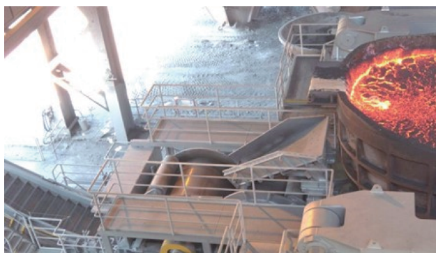
写真1 双ロール式スラグ連続凝固設備
